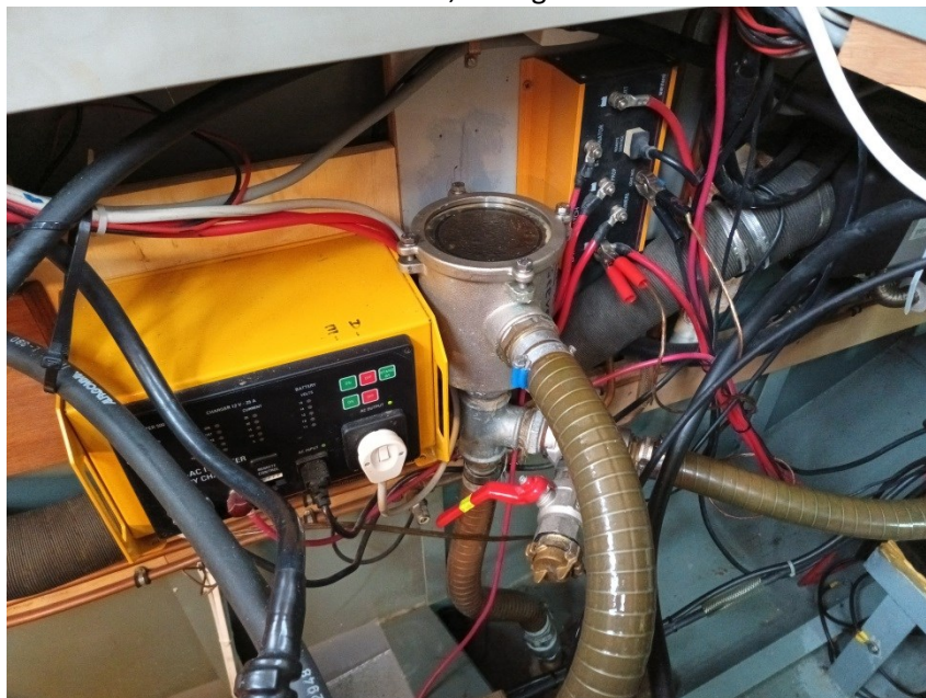
Wechselrichter mit Batterielader und Landanschluss, Filtergefäß Primärkühlkreis
