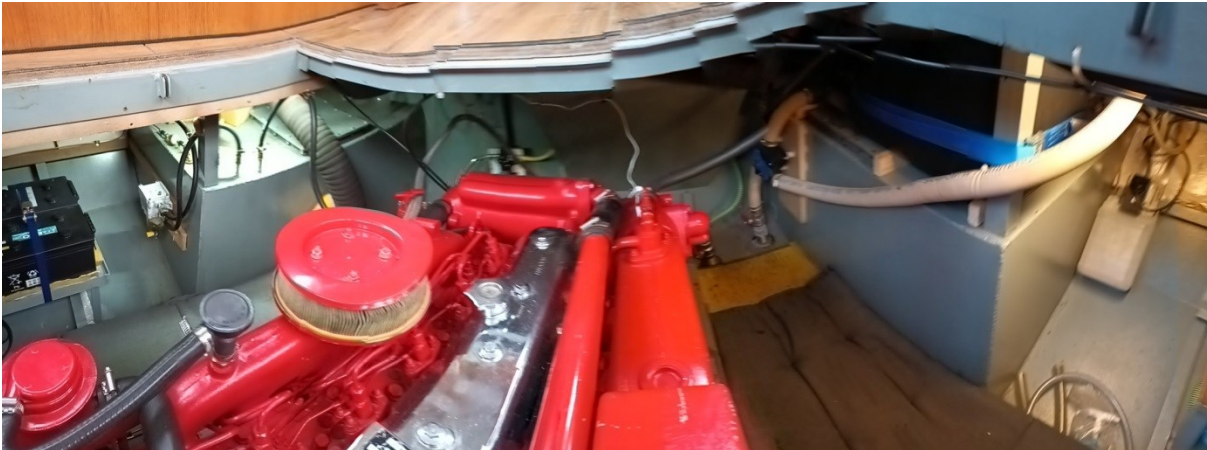
FIAT Iveco Diesel AIFO 8061 12M 6 Zyl. 120 PS, Wellenantrieb Vetus Bullflex
